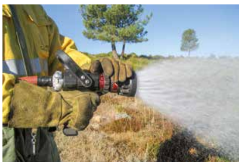
Figura nº 14. Lanza en pulverización con P < 5 \text{ Kg/cm}^2
