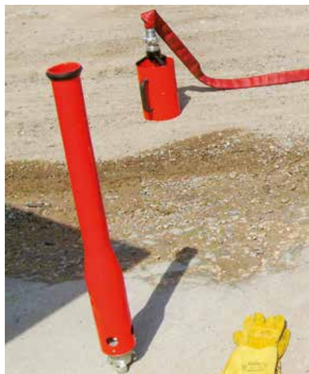
Figura nº 53. Lanzas con dispositivo generador
