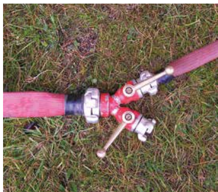
Figura nº 23. Tendido con bifurcación Ø 45 a Ø 25
