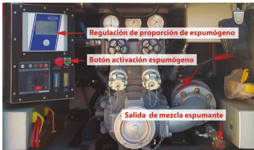
Figura nº 58. Bomba Ruberg (Incipresa) con proporcionador Johstadt PV integrado
