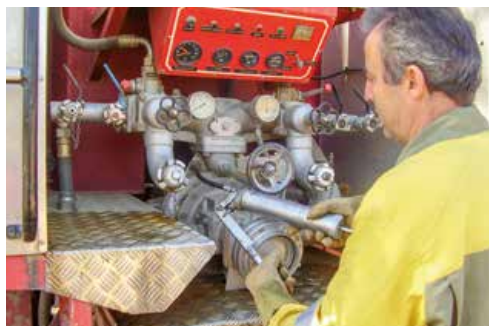
Figura nº 51. Conductor engrasando bomba y toma de fuerza
