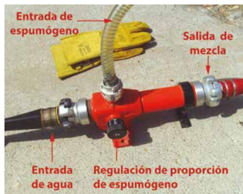
Figura nº 61. Detalle del inyector portátil
