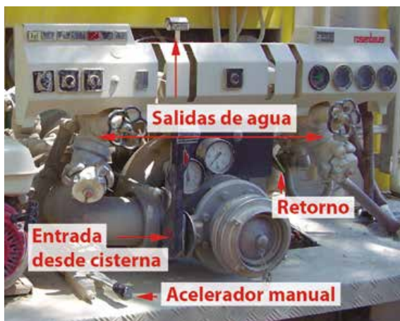
Figura nº 41. Bomba de baja presión
