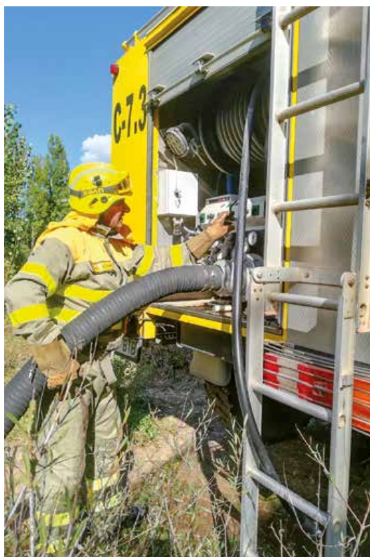
Figura nº 45. Carga del vehículo por los mangotes
