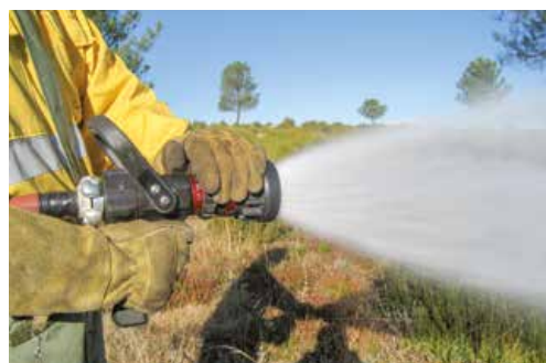
Figura nº 13. Lanza en pulverización con P > 15 \text{ Kg/cm}^2
