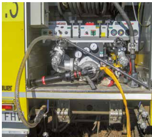
Figura nº 56. Bomba Rosenbauer con proporcionador FIX MIX integrado, lanza con generador y espadín de limpieza
