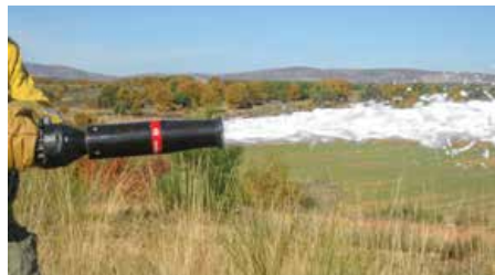
Figura nº 54. Lanza echando espuma a P > 15 \text{ Kg/cm}^2
