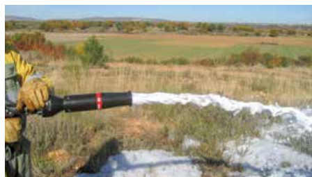
Figura nº 55. Lanza echando espuma a P < 5 \text{ Kg/cm}^2
