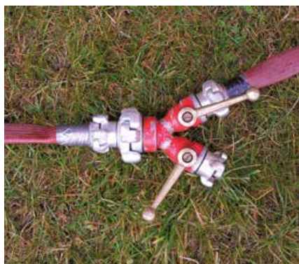
Figura nº 25. Tendido con bifurcación y reducción de Ø 25 a Ø 25
