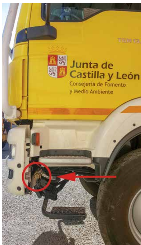
Figura nº 20. Detalle de racor delantero
