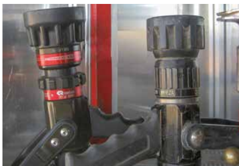
Figura nº 12. Lanzas con regulación de caudal
