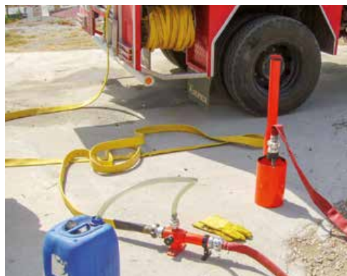
Figura nº 60. Inyector portátil y lanza con generador
