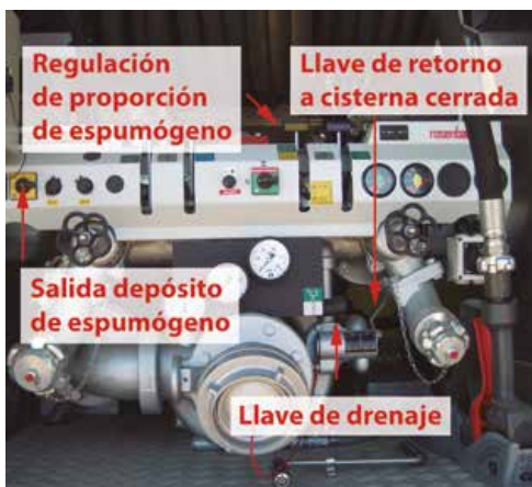
Figura nº 57. Mandos del proporcionador FIX-MIX (Rosenbauer)
