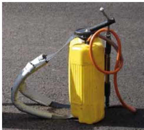
Figura 52. Extintor de mochila
