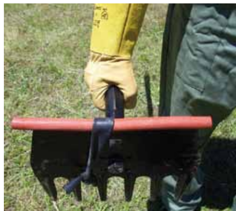
Figura 59. Protección del filo
