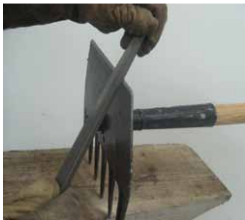
Figuras 71 y 72. Afilado del palín y el macleod
