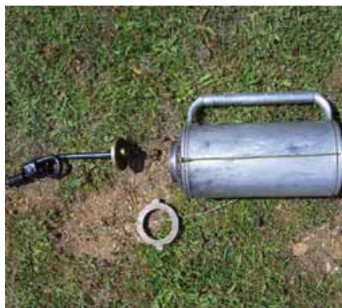
Figura 63 y 64. Antorcha de goteo
