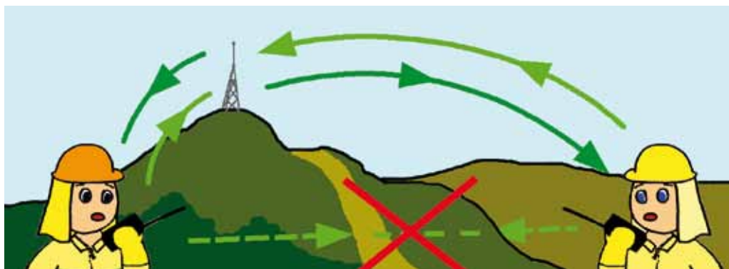
Figura 96. Funcionamiento canal en semidúplex
