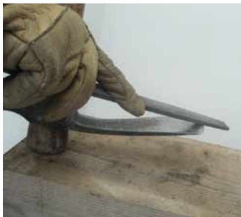
Figuras 69 y 70. Afilado del hacha y azada del pulaski
